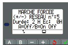
La MARCHÉ FORCÉE permet de forcer le système à sortir du MODE SURVEILLANCE provisoirement durant un temps programmé (réglage de 1h à 10h, par défaut 2h). Retour automatique en Surveillance à la fin du temps programmé.
