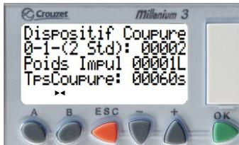
Dans Réglages système, régler le Dispositif de coupure sur 00000, afin de permettre la réouverture du réseau.
