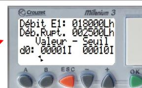
**Note:** sur la version Soft CT9.41, les seuils de déclenchements sont indiqués en Litres, 1 impulsion = 1 ou 5 Litres écoulés, suivant le réglage du poids.
