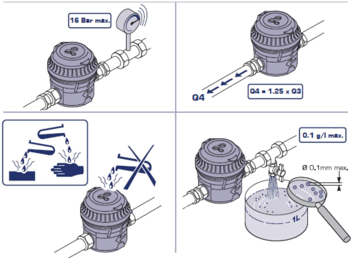
Démonter si nécessaire pour nettoyer le filtre ne amont du compteur
