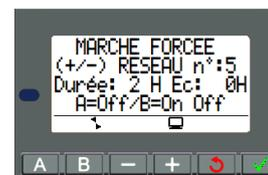
La MARCHÉ FORCÉE permet de forcer le système à sortir du MODE SURVEILLANCE provisoirement durant un temps programmé (réglage de 1h à 4h, par défaut 2h). Retour automatique en Surveillance à la fin du temps programmé.
