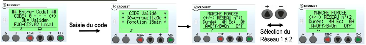
La MARCHÉ FORCÉE permet de forcer le système à sortir du MODE SURVEILLANCE provisoirement durant un temps programmé (réglage de 1h à 200h, par défaut 4h). Retour automatique en Surveillance à la fin du temps programmé.
