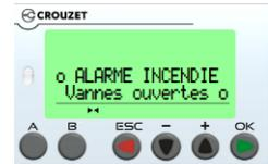
Câbler +24vcc/ IC sur un contact sec NC, asservi au déclenchement de l'alarme incendie. Voir schéma ci-dessous
