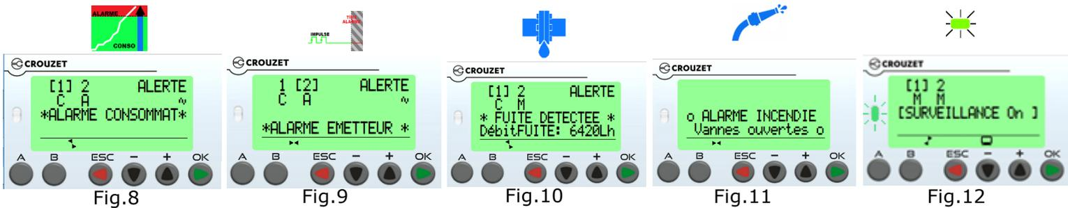
**Réseau [1]:** Le réseau est en Coupure de Sécurité par Alarme Consommation Fig.8
