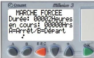
La MARCHÉ FORCÉE permet de forcer le système à sortir du MODE SURVEILLANCE provisoirement durant un temps programmé (Durée non réglable: 00002 Heures)
