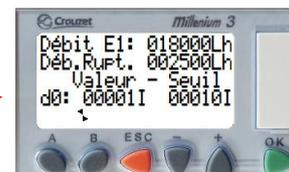
**Note:** sur la version Soft CT9.42, les seuils de déclenchements sont indiqués en Litres, 1 impulsion = 1 ou 5 Litres écoulés, suivant le réglage du poids.
