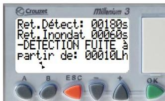
**Retard Détection: 180 sec.** (permet de retarder la détection sur une mise en marche après coupure)
