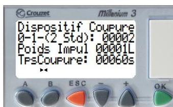
**COUPURE (0/1/2):** (0= pas de dispositif installé, 1= vanne motorisée ouverture progressive, 2= vanne motorisée ouverture standard). Réglage par défaut : **00002**
