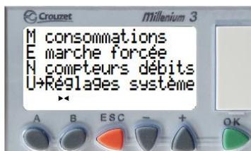
Dans MENU sélectionner Réglages système à l'aide des touches
