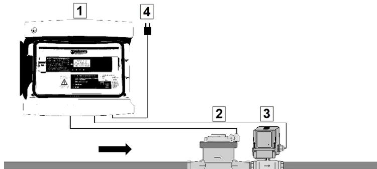
**2** - Le compteur + émetteur Doivent être installé le plus près possible du compteur général juste après celui-ci (Afin de protéger entièrement le réseau d'eau). Vérifier le bon sens lors de montage.
