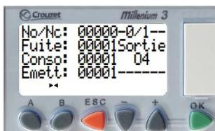
SORTIE O4 (contact sec) réglages par défaut : sur **00000\* (NO)**
