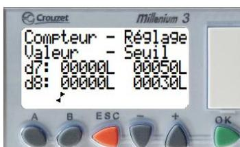
**NOTE:** pas réglage manuel des seuils, le réglage se fait en lançant l'autoréglage dans Réglages système (durée de l'autoréglage: 170H par défaut) [Auto](#)
